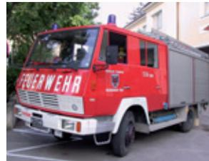
1979-2010 **Tanklöschfahrzeug-Allrad 2000 auf Steyr 791, Aufbau Rosenbauer**
